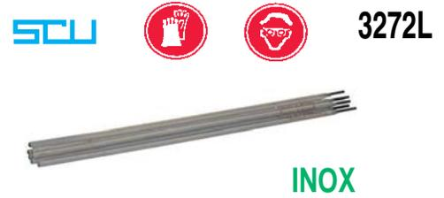
Tipo con rivestimento Basico e a basso contenuto di carbonio. Adatti per saldare acciaio INOX AISI 309 - 309S - 310 310S con acciai comuni in saldature eterogenee.
